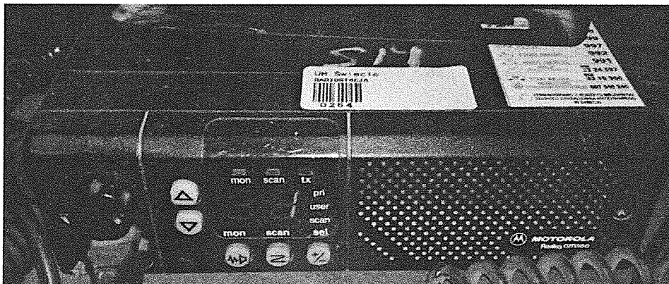
fot. 1 – widok ogólny urządzenia bazowego Motorola GM 300
