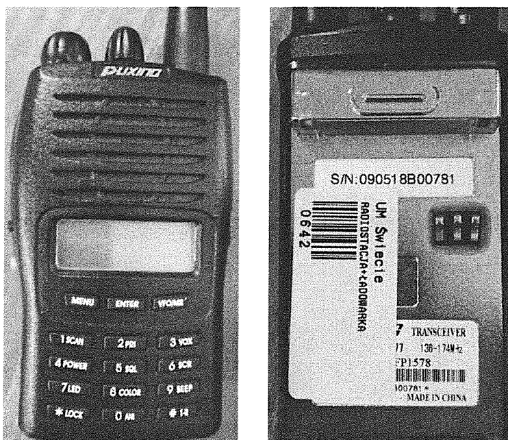
fot. 3 – tabliczka informacyjna i widok ogólny urządzenia noszonego PUXING PX-777
